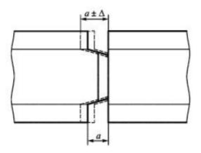
а - ширина зазора по клеевому соединению ящика
