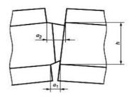
$a_1$  - ширина зазора по клеевому соединению ящика, измеренная снизу;
