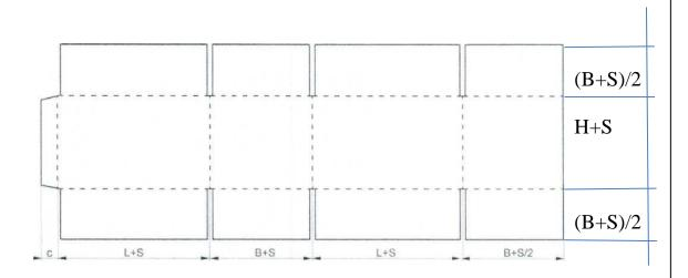
Условные обозначения размеров ящика L, B, H - внутренние размеры ящика (длина, ширина, высота), мм; S - толщина картона, мм; с - 20-50 мм
